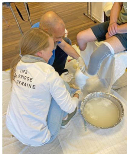
Lidiia bei der Fertigung ihres ersten Testschäfts aus thermoplastischem Kunststoff im Vakuum-Tiefziehverfahren.
