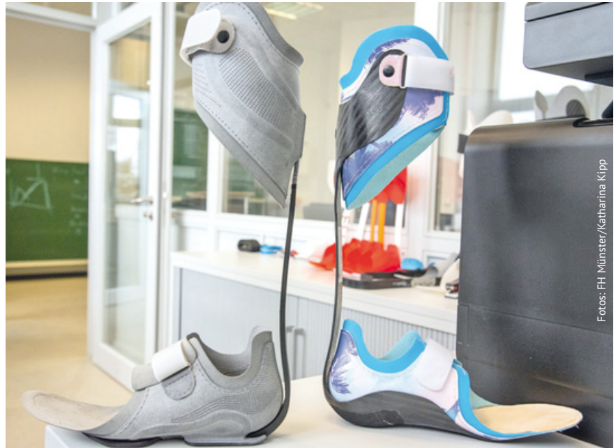
Links die Orthese aus dem 3D-Drucker, rechts das vom Kompetenzzentrum Kramer gefertigte Original.
